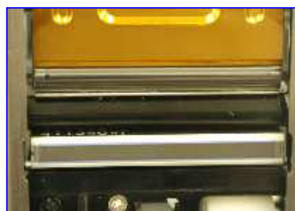
清掃後(正常な状態)
