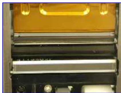
清掃後(正常な状態)
