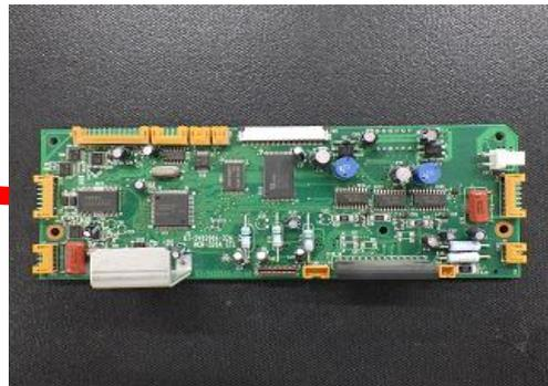
JAE製コネクタ使用TCT-217X CNT基板
