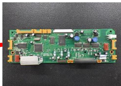
JAE製コネクタ使用TCT-217X CNT基板
