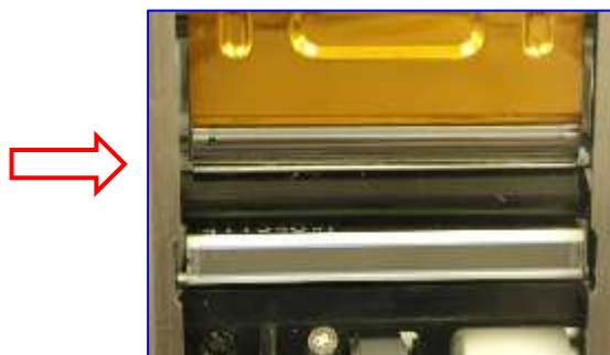
清掃後(正常な状態)
